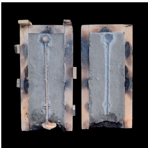
Fig. 7. Il risultato della sperimentazione di fusione in sabbia dello spillone tipo Franzine.
